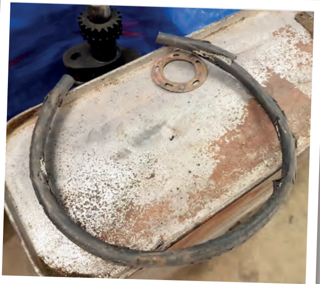
Denne bensinslangen var i bruk ca 3 år. Alltid lurt å sjekke slangane både før sesongstart og elles.
