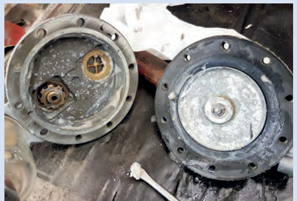
På same måte som ved sandblåsing trenger mediet seg inn alle plassar. Her er ei bensinpumpe demontert for å tørke vekk suppa med glasperler som hadde lagt seg i.
